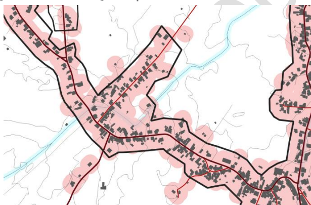
Figura 3.2_Exemplo da relação entre a delimitação de perímetro urbano e o edificado existente (com respetivo buffer )
